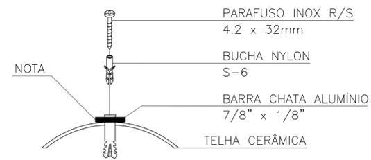
(A) FIXAÇÃO DA BARRA NA TELHA
