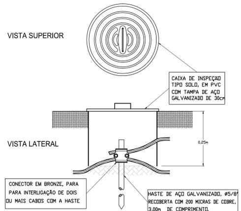
HASTE DE ATERRAMENTO EM CAIXA DE INSPEÇÃO - TIPO SOLO SEM ESCALA
