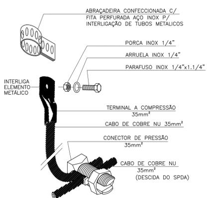
INTERLIGAÇÃO DE ELEMENTO METÁLICO À PARTIR DE CONEXÃO MECÂNICA EM CABO PASSANTE SEM ESCALA
