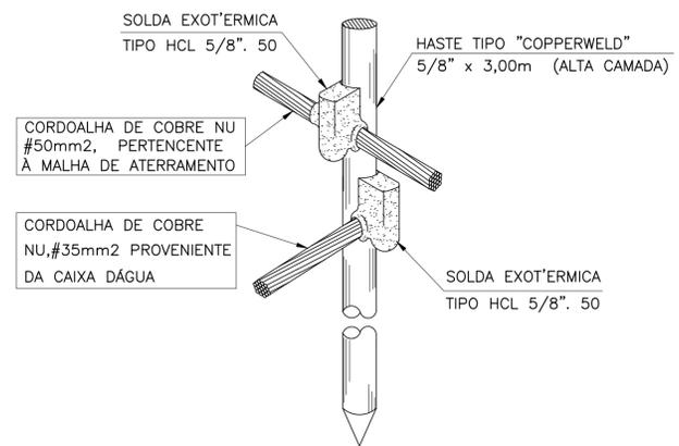
DETALHE DE CONEXÃO DE HASTE DE ATERRAMENTO COM CORDOALHAS DE COBRE USANDO SOLDA EXOTÉRMICA SEM ESCALA
