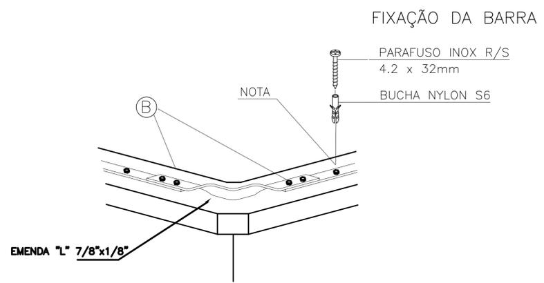
DETALHE DE FIXAÇÃO DA BARRA CHATA EM ALUMÍNIO NO CANTO SEM ESCALA
