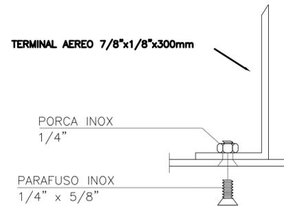
DETALHE DE FIXAÇÃO DO CAPTOR AÉREO NO BARRAMENTO DA GAIOLA SEM ESCALA
