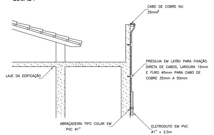
DETALHE DE POSICIONAMENTO DA DESCIDA EM PILAR SEM ESCALA
