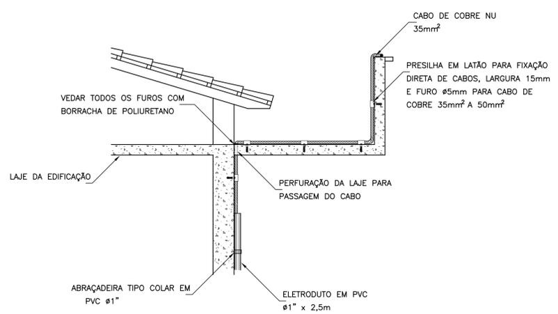
DETALHE DE POSICIONAMENTO DA DESCIDA EM PILAR SEM ESCALA
